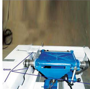
• بدنه دستگاه‌ها از ورق‌های فولادی با ضخامت ۶ میلیمتر
